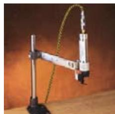
Cilindro de aplicación neumático adecuado para montura para mesa, con una punta romo para la aplicación donde no se necesita ajustar. El accionamiento consiste en una aguja que se proyecta más allá de la punta romo e inserta el sujetador. Se utiliza para colocar sujetadores Extremo T (T-Ends™) en
