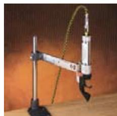
Un cilindro de etiquetado eléctrico adecuado para montura para mesa que comprime y sujeta el artículo y luego inserta el sujetador. Aplicación típica: uso de sujetadores Extremo T (T-Ends™) de 1/2" para unir y ajustar almohadillas quirúrgicas. Se recomienda de 60 a 80 PSI. Equipo opcional:
